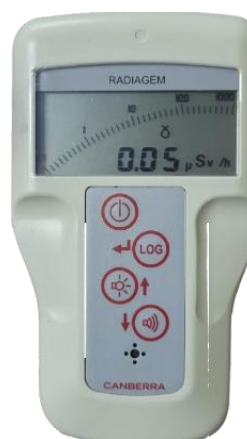
Gambar 1. Surveymeter gamma Canberra tipe RADIAGEM 2000
